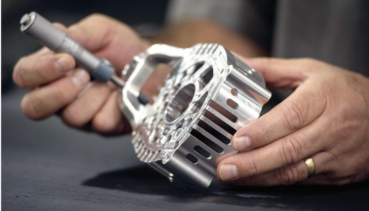
"Molti dei pezzi che produciamo, come i componenti dello sterzo e alcuni pezzi delle sospensioni, sono abbastanza complicati e sono adatti alla tavola rotobasculante Haas sul 5° asse, dove possiamo lavorare i cinque lati con un'unica configurazione"
