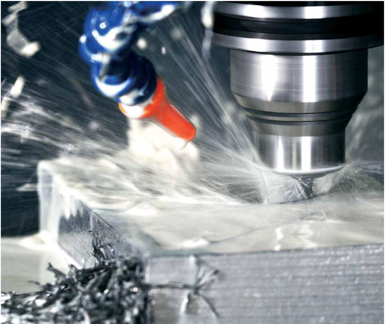
Oggi la maggior parte dei generatori di percorsi utensile crea percorsi a offset costante o parallelo, che incrementano il contatto dell'utensile con il materiale in numerose sezioni lungo l'intero percorso, soprattutto sugli angoli. Alcuni generatori di percorsi utensile più recenti creano percorsi più regolari. Tuttavia questi sistemi regolano l'avanzamento lungo il percorso utensile senza però controllare il contatto.
