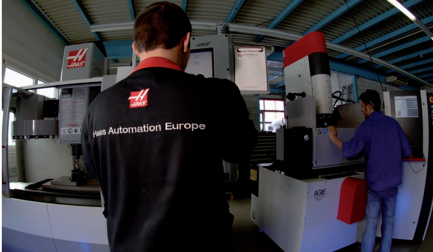
**“Si tratta del nostro ultimo investimento in una macchina utensile”, afferma. “È una fantastica macchina di piccole dimensioni, dalle funzionalità e dalla precisione eccellenti. La utilizziamo per produrre elettrodi ancora più piccoli, con spessori delle pareti che raggiungono gli 0,3 mm.**
